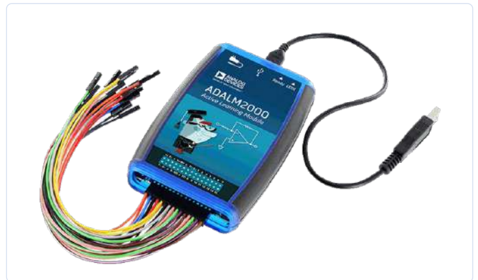
Figure 6. Désormais outil standard des FAE d'Analog Device, l'ADALM2000 (MK2) rassemble oscilloscope, générateur de fonctions, analyseur logique et générateur de motifs. (Source : Analog Devices)
