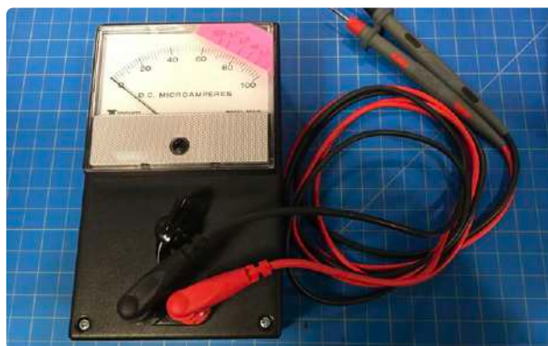
Figure 8. L'étalonnage du compteur est facilement réalisé avec quelques résistances de 2\ \Omega et un morceau de Post-it.
