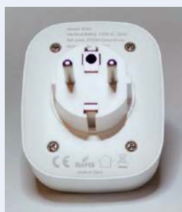
Figure 9. Quatre vis ferment le boîtier de l'EU6S.
