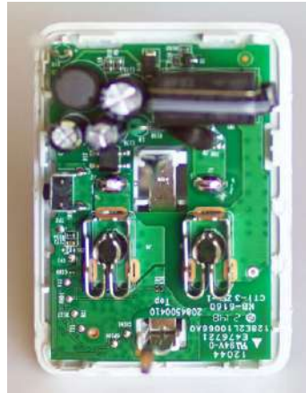
Figure 27. Les broches du milieu sont soudées.
