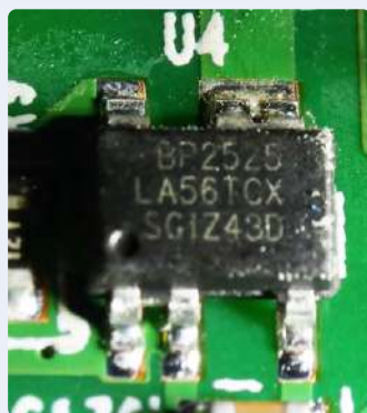
Figure 30. Le BP2525 est monté sous le circuit imprimé.
