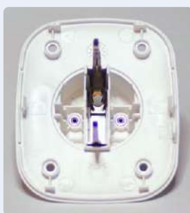
Figure 10. Les vis du circuit imprimé de l'EU6S sont difficiles d'accès.
