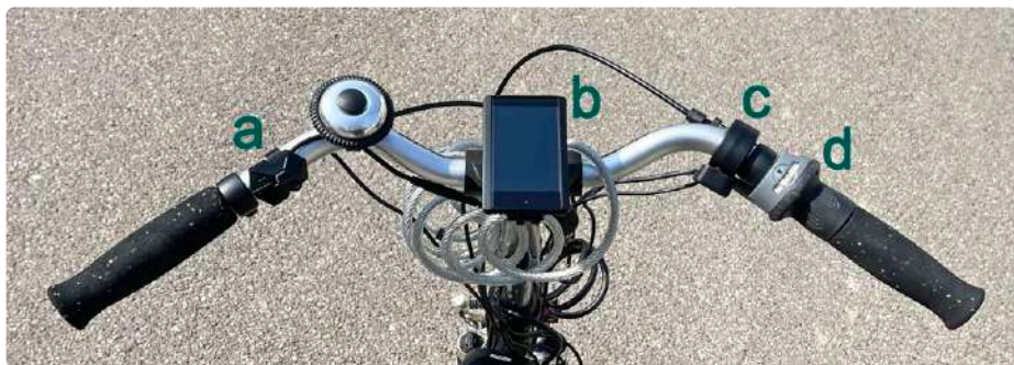
Figure 9. Nouveaux accessoires de guidon : (a) boutons de commande, (b) écran, (c) accélérateur au pouce (aide au démarrage) et (d) poignée de changement de vitesse avant la conversion à l'Inter-5E.
