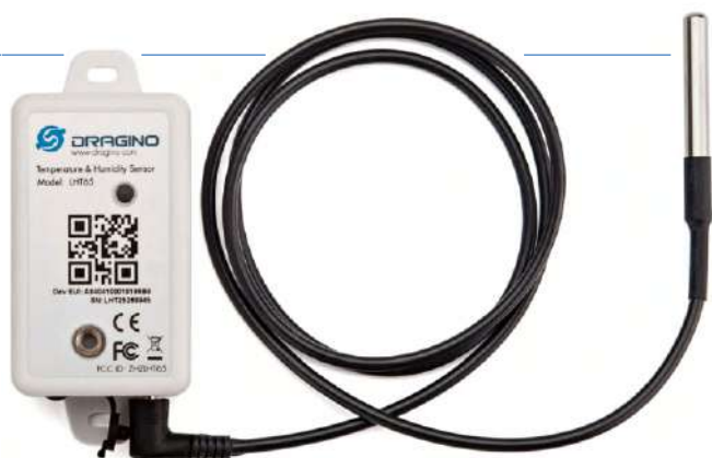
Figure 1. Dragino LHT65-EU868-E1 avec capteur DS18B20 externe.
