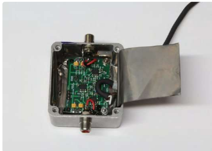
Figure 5. Le « sandwich » de circuits imprimés installé dans un boîtier en aluminium.
