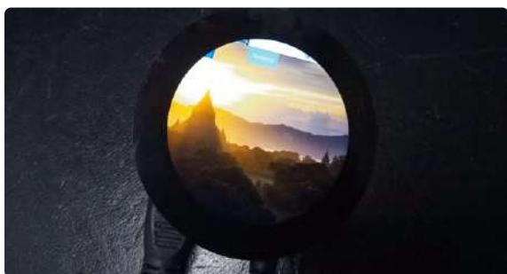
Figure 1. L'HyperPixel 2.1 Round montrant le bureau du Raspberry Pi Buster.
