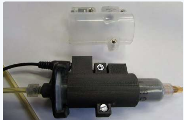
La version noire imprimée en 3D qui s'adapte à la seringue de 30 cc en noir
