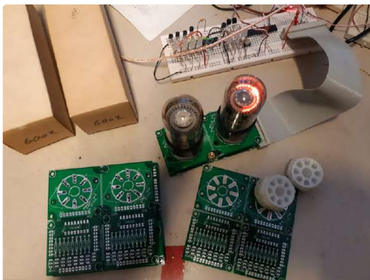
Figure 4. Circuits imprimés et unités assemblées.
