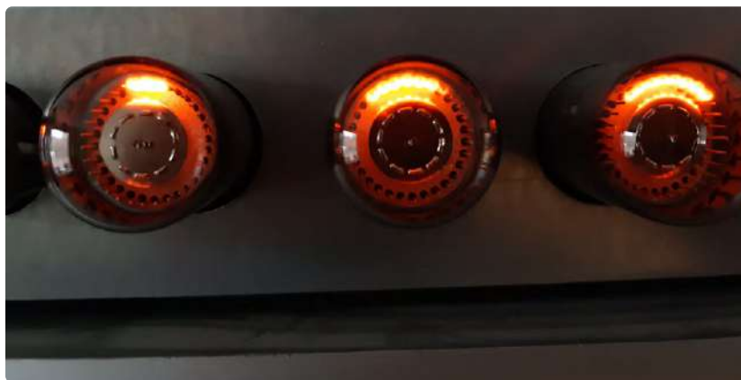
Figure 7. Zoom sur trois afficheurs dekatron.
