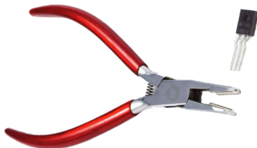
Figure 17. Pour éviter les contraintes dues à l'expansion thermique, les pattes des transistors de commande sont légèrement pliées. Cela peut être fait très facilement avec les pinces spéciales montrées ici, mais aussi avec des pinces à becs ronds.
