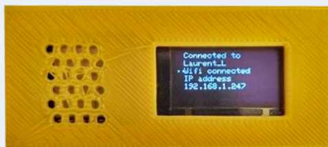
Figure 5. Une unité de débogage série sans fil complète logée dans son boîtier imprimé en 3D.
