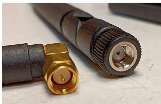
Figure 2. Antennes avec connecteurs SMA. La gauche est adaptée pour Opera Cake et HackRF One, pas celle de droite.
