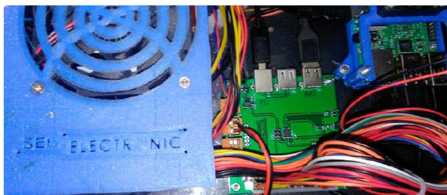
Figure 4. Alimentation ATX connectée au PCB.
