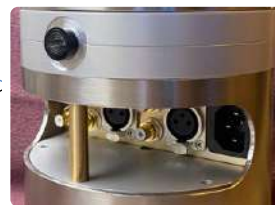
Figure 19. Une cavité à l'arrière abrite tous les connecteurs : entrées, sorties et alimentation secteur.
