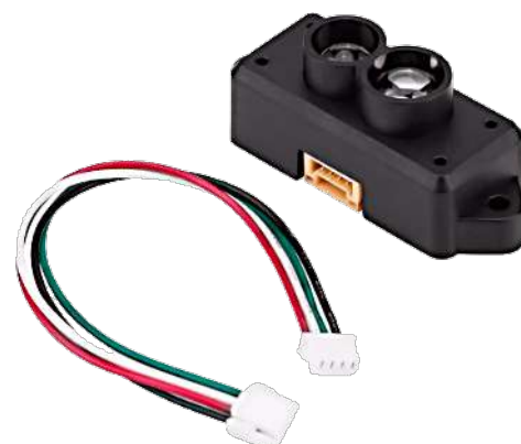
Figure 1. Le lidar TFMini-S à faible coût a une portée de 12 m avec une résolution de 1 cm.
