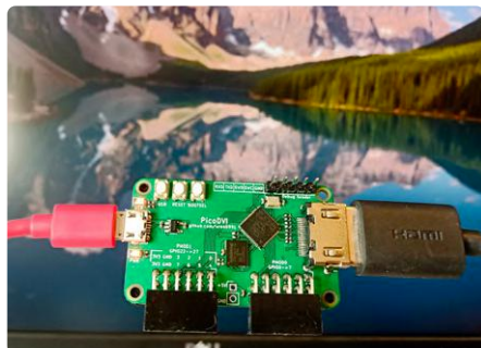
Figure 25. PicoDVI - RP2040 avec sortie vidéo DVI (source : Wren6991 / https://elektor.link/picodviimg ).
