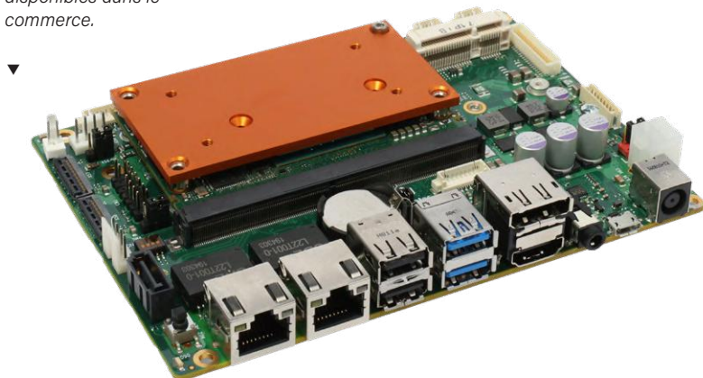
Figure 4. Carte porteuse SMARC 2.1 et carte SBC évolutive de 3,5 pouces : le conga-SMC1 comble le fossé entre les conceptions basées sur des modules et les cartes standard hautement évolutives disponibles dans le commerce.
