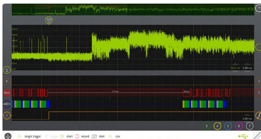
Figure 10. Courant d'alimentation (trace jaune) d'une carte bancaire lors de la vérification d'un code confidentiel incorrect.
