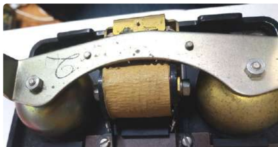
Figure 4. Le mécanisme de la sonnerie de l'ancien téléphone.
