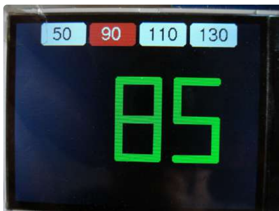
Figure 4. Sur l'écran 2, la vitesse réelle est affichée en chiffres de style 7 segments.
