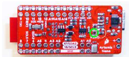
Figure 5. Carte Artemis Nano. R1 est entouré en blanc. Contrairement à la Thing Plus, il n'y a pas de connecteur EN mais un connecteur « PSWC ». La broche ENABLE du TPL5111 doit être reliée au trou entouré en vert une fois que R1 est retiré. Notez que R1 se trouve à l'arrière de la carte et doit être retirée avant le montage.
