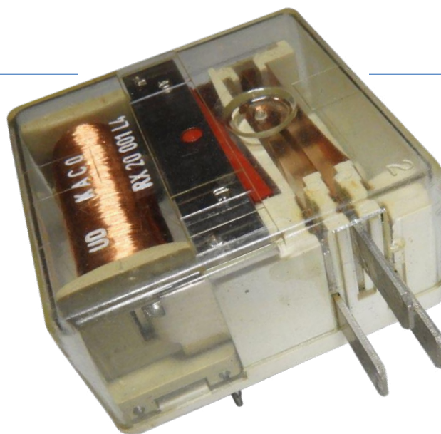
Figure 1. Relais de puissance ordinaire utilisé dans les appareils de commutation à distance de l'alimentation secteur.
