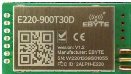
Figure 2. Le module E220-900T30D intègre un amplificateur de puissance de 8 dB qui porte la puissance d'émission à 30 dBm soit 1 W.
