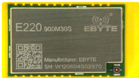
Figure 4. Les modules dont le nom se termine en 'S' offrent une sortie antenne IPEX / U.FL.
