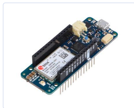
Figure 6. Module Arduino MKR GSM 1400 pour communication en réseau GSM/3G.
