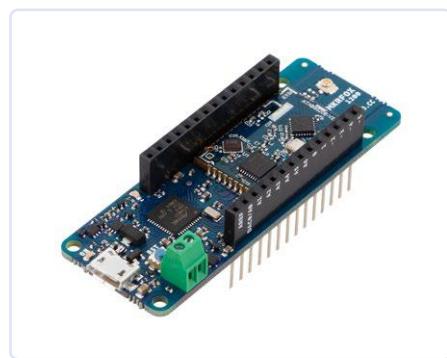
Figure 5. Module Arduino MKR FOX 1200 pour la communication dans le réseau Sigfox.
