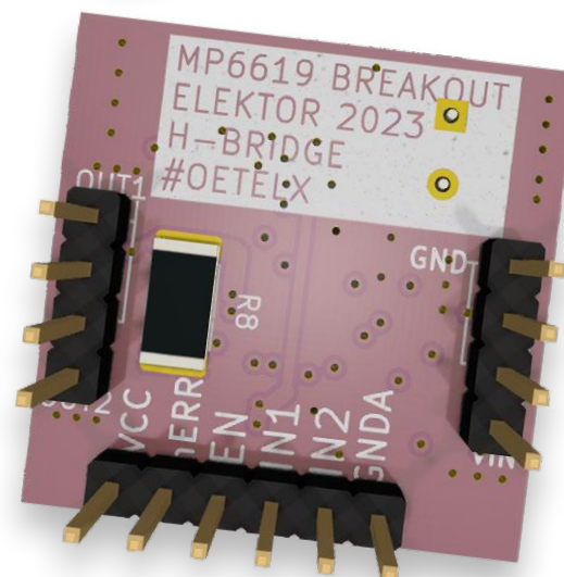
Figure 6. Modèle 3D du BoB (face inférieure) avec des têtes de broches.
