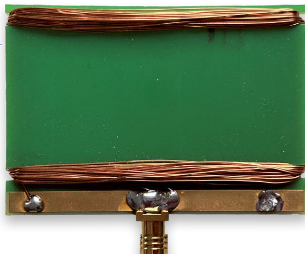
Figure 17. Antenne à cadre maison.
