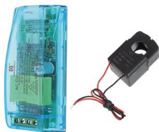
Figure 2. Le capteur PZEM-004T avec un transformateur.
