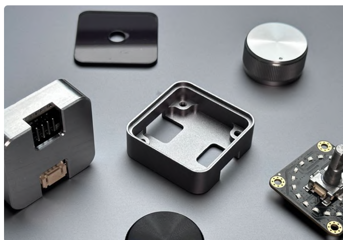
Figure 22. Le boîtier avec d'autres pièces nécessaires, juste avant l'assemblage final.
