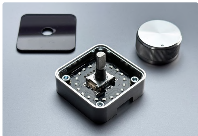
Figure 23. Le boîtier usiné avec l'encodeur monté.
