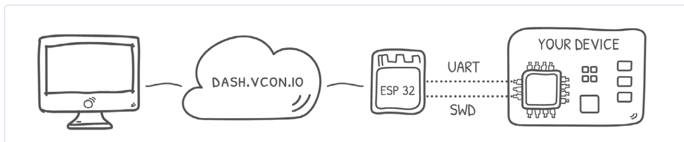
Figure 1. Configuration de l'ESP32 en tant que programmeur contrôlé à distance et inscription sur vcon.io.
