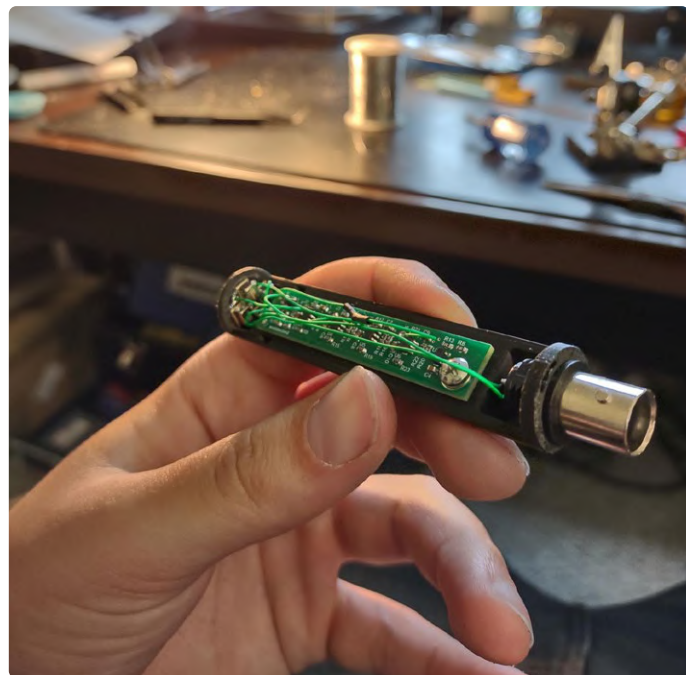
Figure 5. Un microphone construit, emballé dans un boîtier imprimé en 3D avec le couvercle enlevé. L'emballage final est surdimensionné pour une conception nominale de 0,5 pouce, mais il est assez approprié pour une démonstration rapide du concept.
