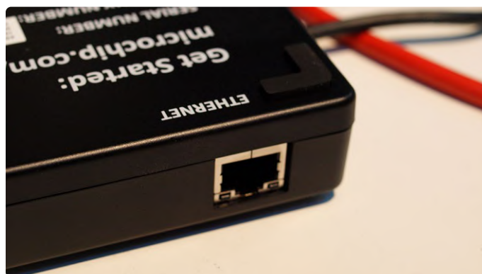
Figure 1. Cette connexion permet également l'alimentation par Ethernet.
