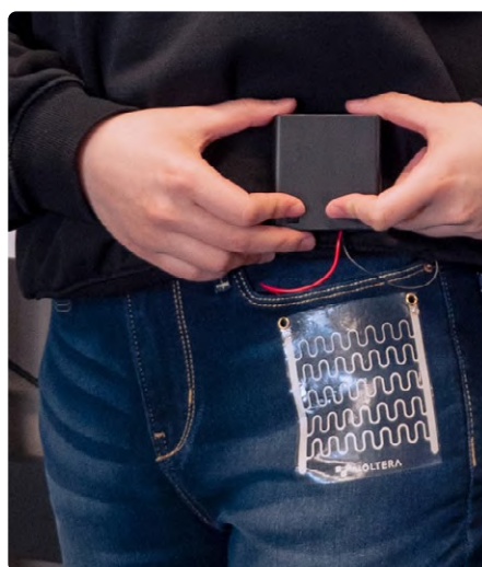
Figure 5. Un chauffe vêtement flexible comme celui-ci pourrait être utilisé pour favoriser la circulation sanguine en dilatant les vaisseaux sanguins.
