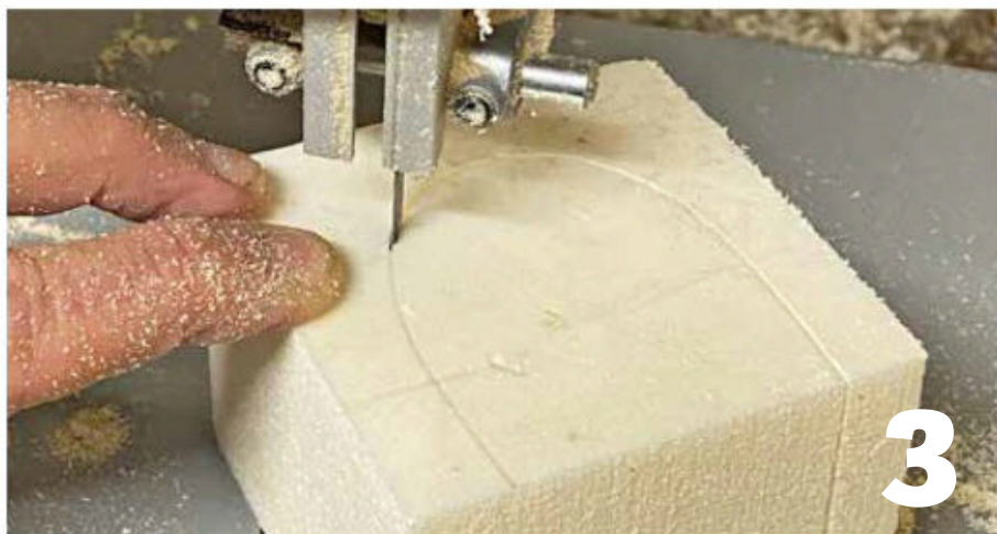
Opération nécessitant une bonne concentration : découpe de la voûte à la scie à ruban.
