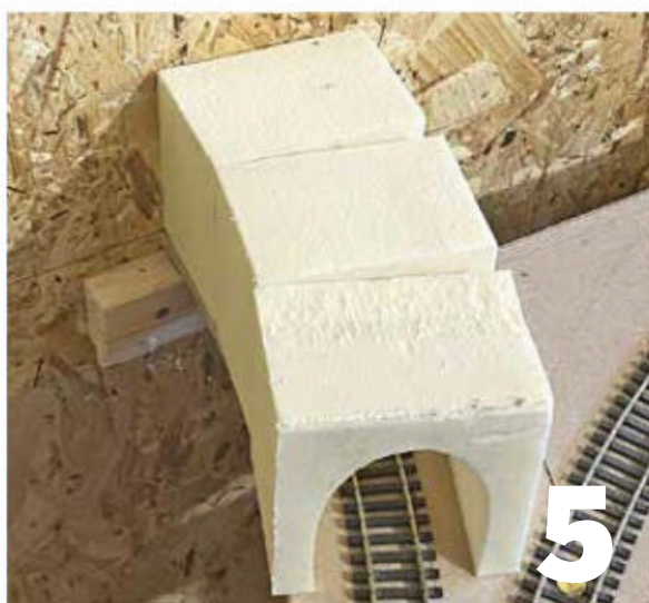
Dans le cas de ce futur tunnel en courbe, un premier essai de mise en place sert à tracer l'angle de raccordement de chaque section.
