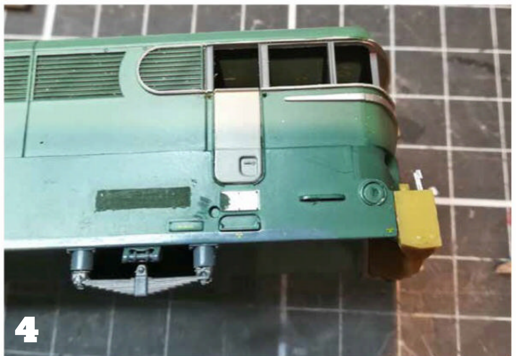
4 Adaptation de la nouvelle suspension. On voit aussi la tranche de la traverse renforcée en résine.
