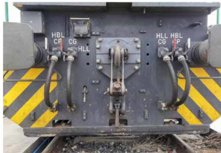
Détail de la traverse de tamponnement.
