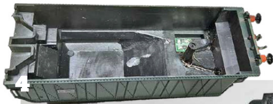
Une petite platine Lais supporte les résistances CMS de 10 kohms des LED.
