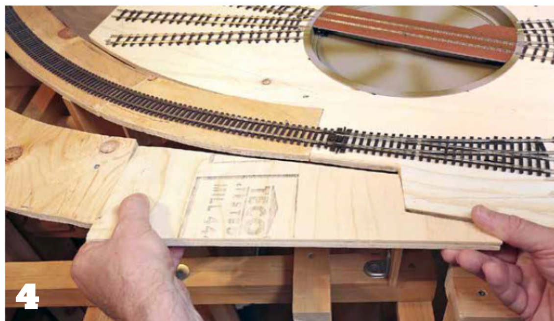
4 Découpe du plateau pour la pose des doucines. Le plateau de l'annexe-traction est découpé pour permettre la mise en place des doucines assurant une transition entre le palier de la gare et la déclivité maximale de 25 mm/m en pleine ligne.
