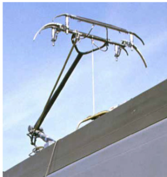
Prototype du pantographe AX monté sur la rame TGV 79 : le double archet possède des palettes indépendantes.
