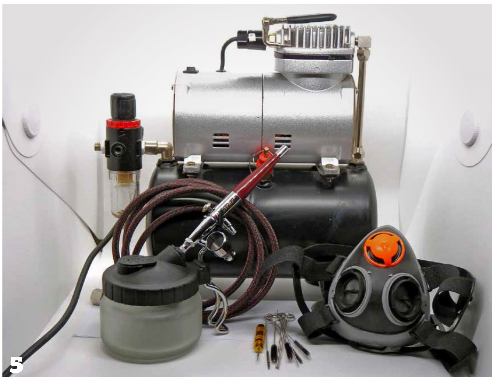
5: Le compresseur, l'aérographe, le tuyau, le kit de nettoyage et le masque de protection constituent l'équipement idéal pour débuter.
