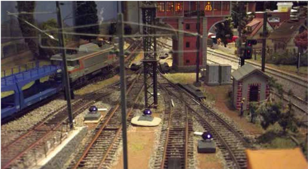
9: À la sortie d'un faisceau de service, des carrés violets nains et un ralentissement présentant le carré, sur la droite.
