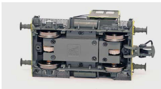
Le bogie moteur est semblable à celui du Moyse.
