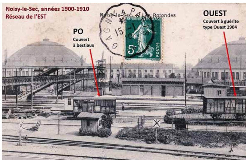
Noisy-le-Sec, réseau de l'Est, vers 1900-1910. Un couvert à rideaux ancien du PO et un couvert à guérite type 1904 de l'Ouest, moderne pour l'époque, stationnent devant les rotondes du dépôt. Collection D. Vauvillier.
