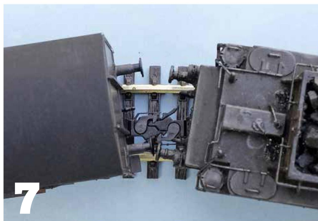
7 Test en courbe de rayon 360 mm : ça marche ! Il y aura de la marge sur le réseau dont les courbes sont de 600 mm minimum.
