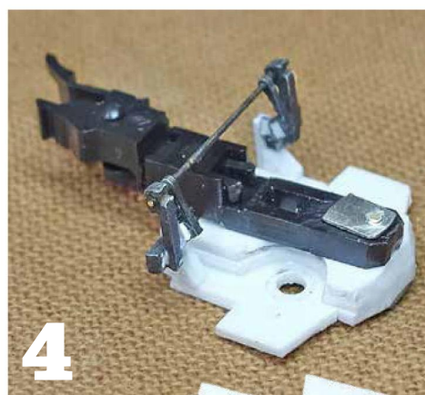
4 Le timon monté sur l'embase et la timonerie de frein refaite.
