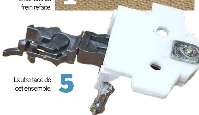
4 Le timon monté sur l'embase et la timonerie de frein refaite.
