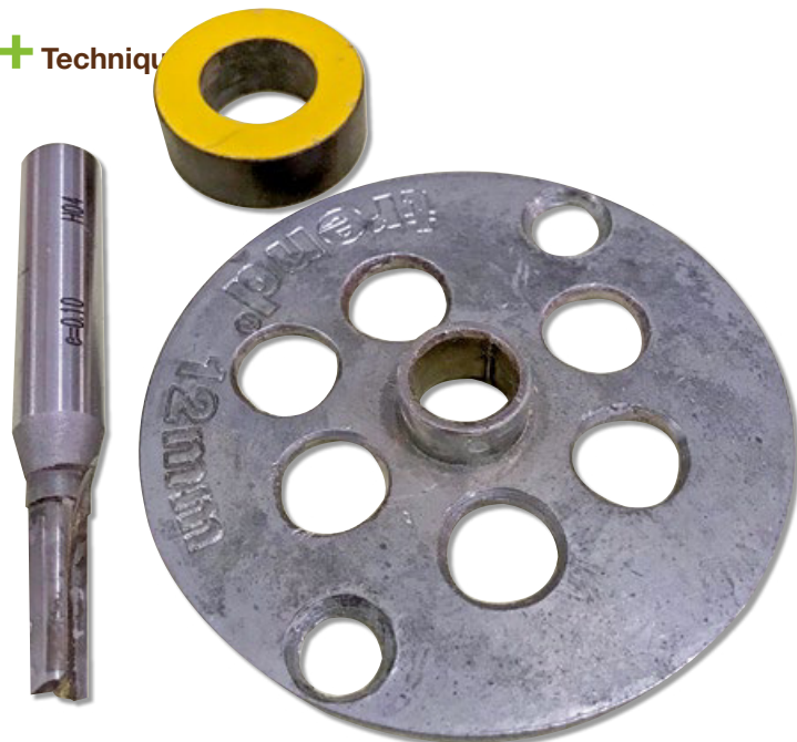
Le jeu d'outillage utilisé : guide de 12, baguette de 22, fraise de 5.
