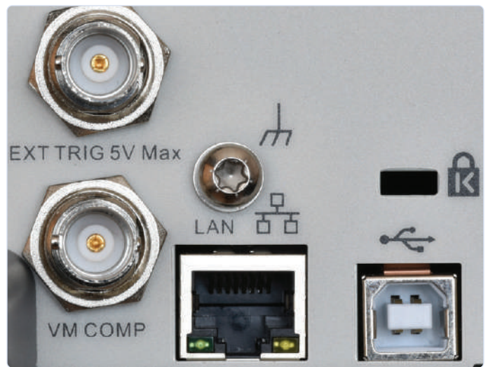
Figure 3. Le multimètre peut être connecté à un PC par USB ou LAN.
