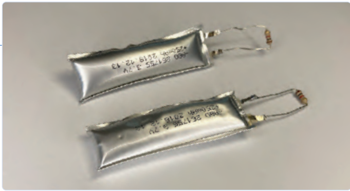
Figure 8. Batterie plate endommagée et gonflée.
