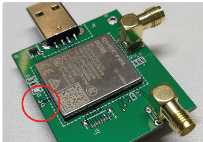
Figure 1. Les deux pastilles non connectées sur le côté gauche sont reliées au module de débogage UART. Le connecteur est monté sur demande uniquement.
