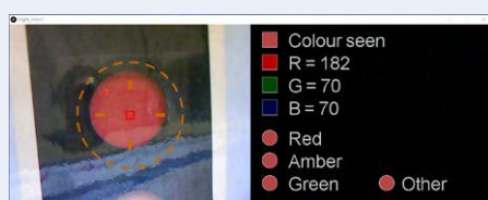
Figure 7. Réponse de tlight_detect.pde avant d'apprendre des couleurs.
