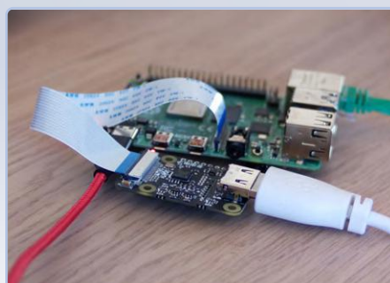
Figure 18. Installation terminée avec le pont HDMI-CSI.
