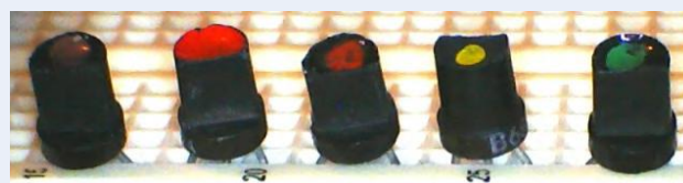
Figure 1. Transistors 2N2926. La couleur indique le gain H_{fe} du transistor : brun 35-70 ; rouge 55-110 ; orange 90-180 ; jaune 150-300 ; vert 235-470.
