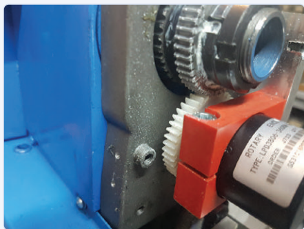
Figure 6. ...et entraîné par un engrenage récupéré sur la boîte de vitesses.
