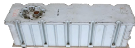
Figure 2. Amplificateur en bande S Collins Radio à tube à ondes progressives utilisé pour la communication avec la Terre pendant la mission Apollo. (Source : Ken Shirriff)
