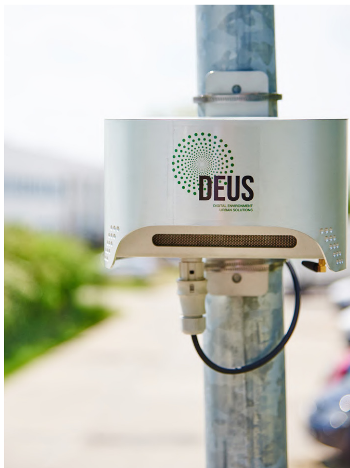
Figure 5. Les capteurs de particules DEUS POLLUTRACK recueillent des données à partir d'unités IdO fixes et mobiles. Les données sont transmises au back-end à l'aide des réseaux cellulaires 4G et 5G. (Source : DEUS POLLUTRACK)
