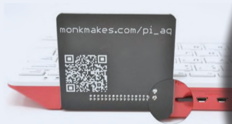
Figure 2. Kit de qualité de l'air connecté à un Raspberry Pi 400. (Source : MonkMakes)
