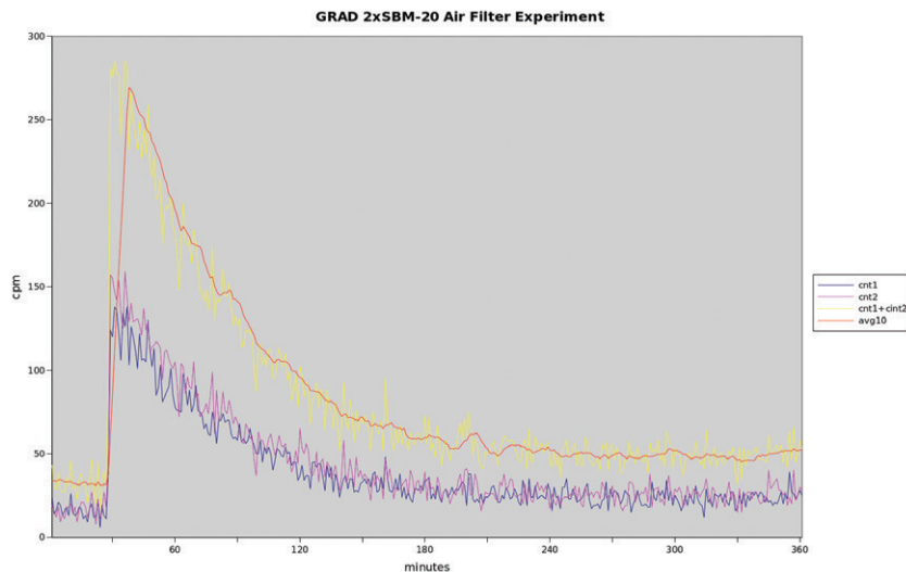
Figure 8. Rayonnement de désintégration du radon du filtre d'un climatiseur.
