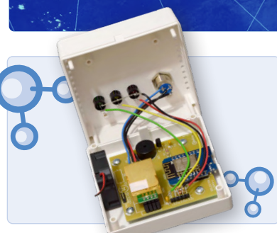
Détecteur de CO 2 Une solution « maison » pour surveiller la qualité de l'air
