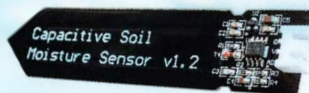
Figure 3. Exemple de capteur capacitif basse fréquence. (source : [3]).
