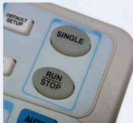
Figure 10. Les boutons 'Run', 'Stop' et 'Single' permettent de capturer des événements peu fréquents ou de geler les traces pour prendre des mesures sans que le signal ne disparaisse.
