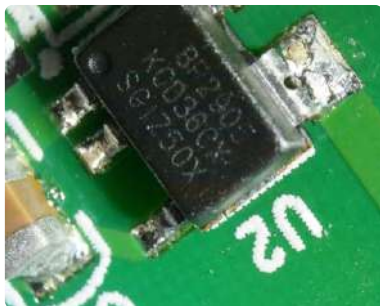
Figure 35. Le CI BP2905 est compatible avec le BP2525.
