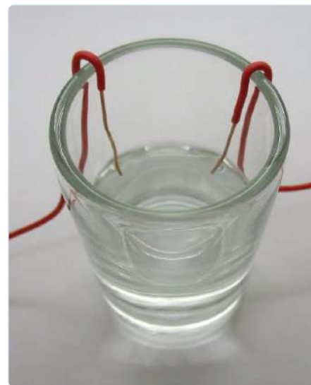
Figure 6. Montage expérimental pour un condensateur à double couche.
