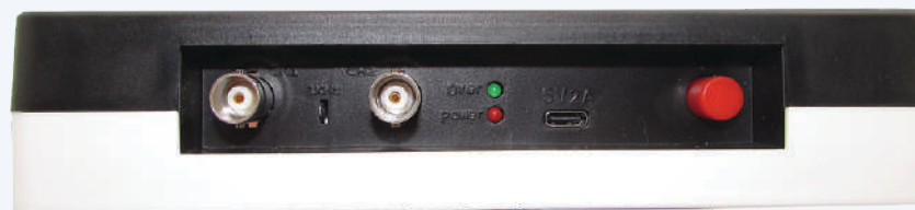
Figure 2. Interrupteur d'alimentation, connecteurs et témoins.
