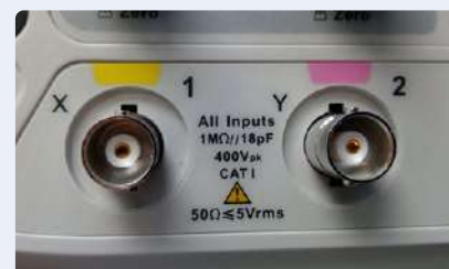
Figure 5. Les entrées X et Y sont utilisées en mode XY et permettent de créer, par exemple, des figures de Lissajous.
