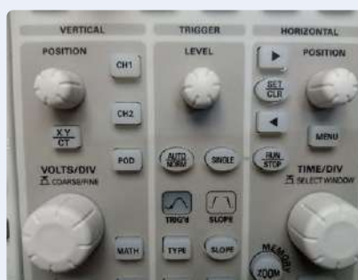
Figure 4. Les trois principales sections de commande de tout oscilloscope. 'Vertical', 'Horizontal' et 'Trigger'.
