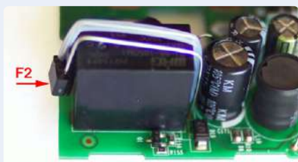
Figure 32. Le fusible thermique est monté près du boîtier du relais.
