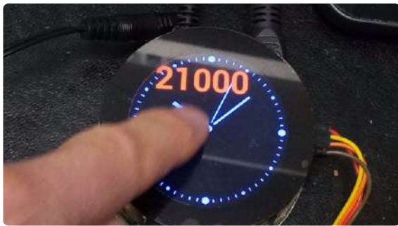
Figure 2. L'horloge compteur d'abonnés YouTube permet de faire glisser sa valeur.
