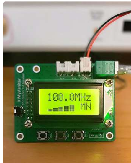
Figure 12. Le récepteur réglé sur 100 MHz avec fort signal mono.
