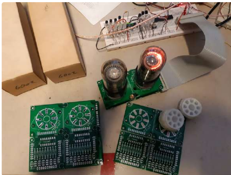
Figure 4. Circuits imprimés et unités assemblées.
