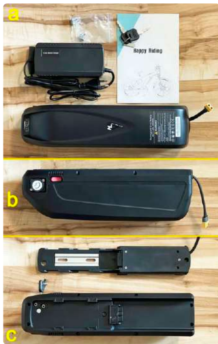
Figure 4. La batterie du cadre 48 V : (a) chargeur, guide de l'utilisateur, clés et batterie, (b) vue du côté gauche de la batterie et (c) vue de dessous de la batterie et du support du cadre.
