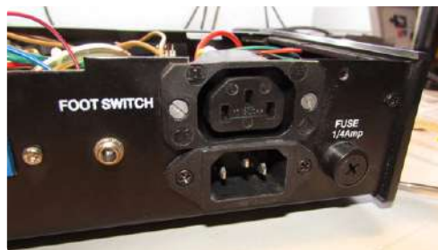
Figure 6: Prise de courant pour le compresseur.
