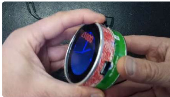
Figure 3. L'HyperPixel 2.1 Round a le même diamètre que l'intérieur d'une boîte de Pringles.
