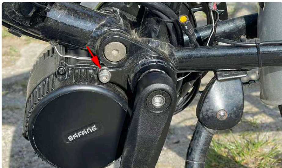
Figure 8. Moteur et support gauche. Mon boîtier de pédalier mesurait 70 mm de large, donc le support nécessitait des rondelles en acier inoxydable (flèche) avec des trous de 6 mm.
