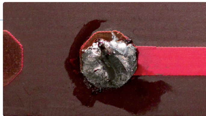
Figure 1. Rien de bon : une bille de soudure froide.
