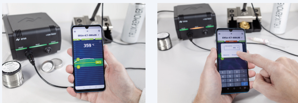
Figure 3. La connectivité de l'i-CON TRACE permet de documenter toutes les étapes du processus de soudage : identification du circuit imprimé, panne utilisée, température et temps de contact. À cet effet, le TRACE COCKPIT pour les ordinateurs ou la TRACE APP pour les appareils mobiles sont disponibles.
