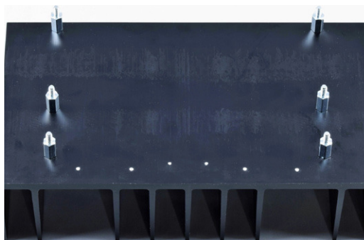
Figure 12. Emplacements marqués des trous percés pour le montage des transistors de puissance.
