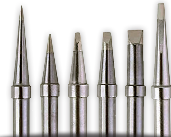
Figure 6 : Différentes pannes à souder.
