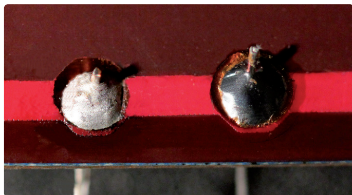
Figure 3. Aspects différents : un point de soudure sans plomb (à gauche) et un point de soudure au plomb conventionnel (à droite).
